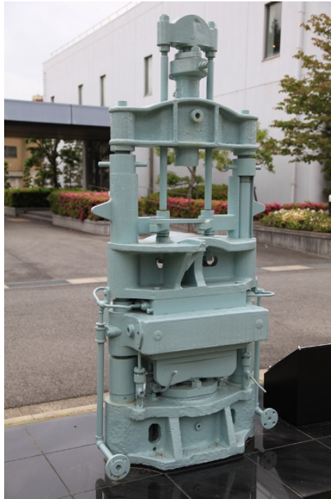
セルロイド圧搾用試験機
